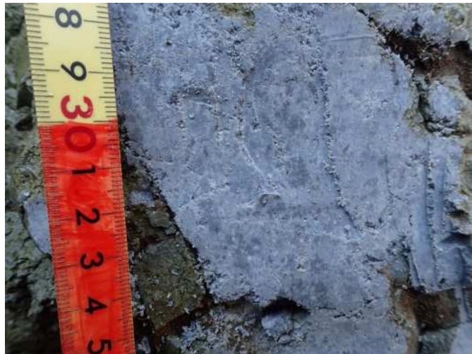
写真⑥ 褐色斜面堆積物とその下に露出した緑白色に変質した溶岩（盛り土下端付近の溪床）
