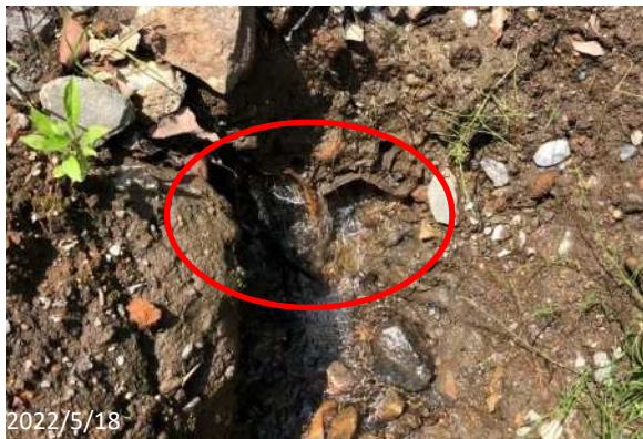
写真⑩ 盛り土直下の溪流堆積物からの大量湧水
