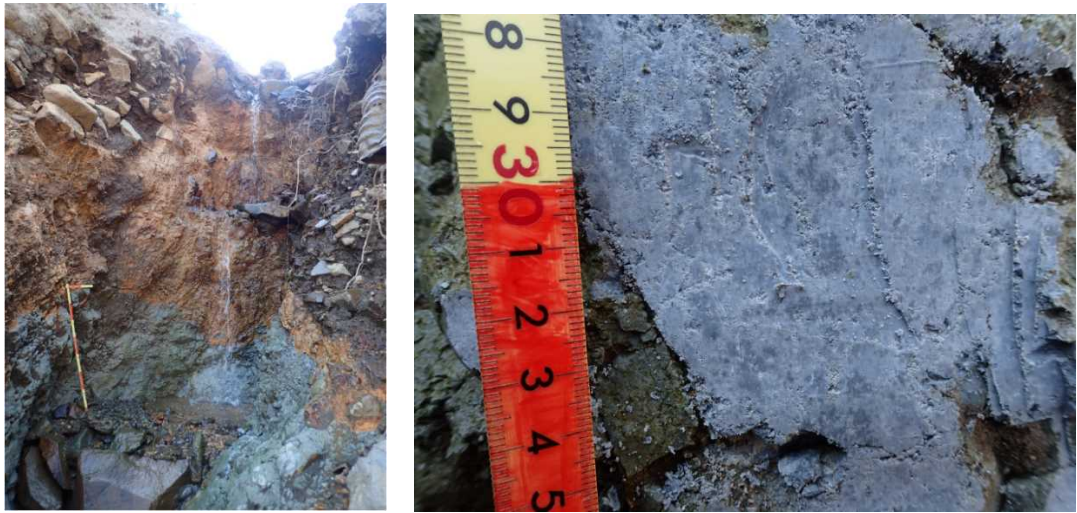
図 3-8 赤褐色の変質層の下位に露出した、緑白色に変質した層（盛り土下端付近の溪床）
