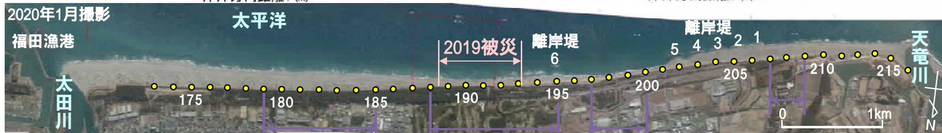
区域では、6号離岸堤西側のNo.197では汀線付近が削られる一方、No.198、No.199では沖合に砂が堆積してバーの形成が顕著になっている。No.188～No.195と調和的な地形変化が起きていた。
