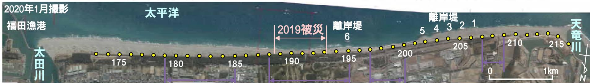
区域では、No.188およびNo.189ではバーの形成とともにバーの岸側直近とバー沖で侵食が起きた。No.190、No.191では堤防の侵食が著しく、バーでの堆積面積と同等の土砂が侵食により供給された。
