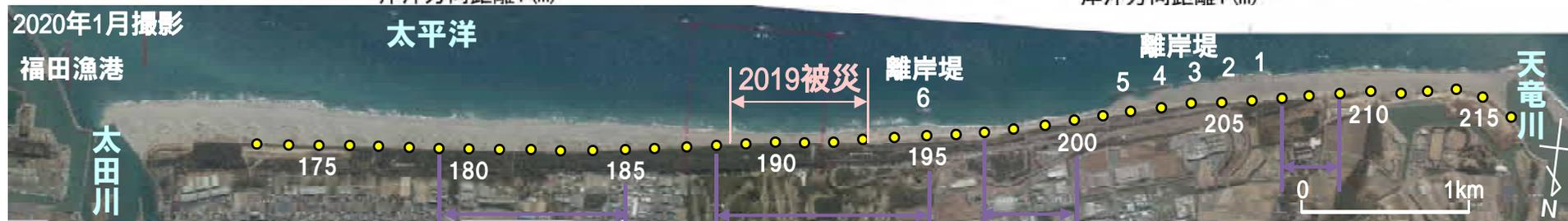
区域では、破堤箇所であるNo.192およびNo.193では、汀線沖で大規模なバーが形成された。既設コンクリート堤防区間であるNo.194、No.195でもバーが形成された。東側から沿岸漂砂により運ばれた砂が堆積したことが分かる。
