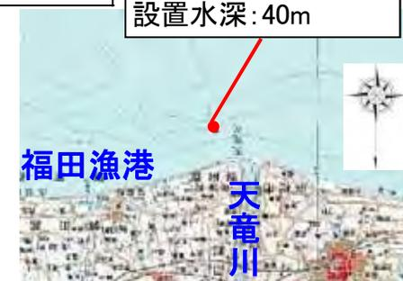
**【遠州灘沿岸海岸の計画外力 (50年確率波)】 : 沖波波高 $H_0=9.0\text{m}$ , 沖波周期 $T_0=17.0\text{s}$**
