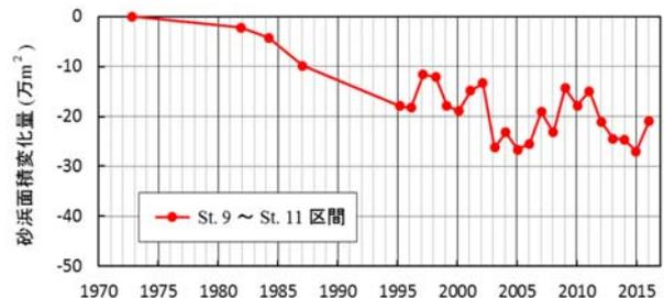
今切口西側のSt.9~St.11区間での砂浜面積の変化
