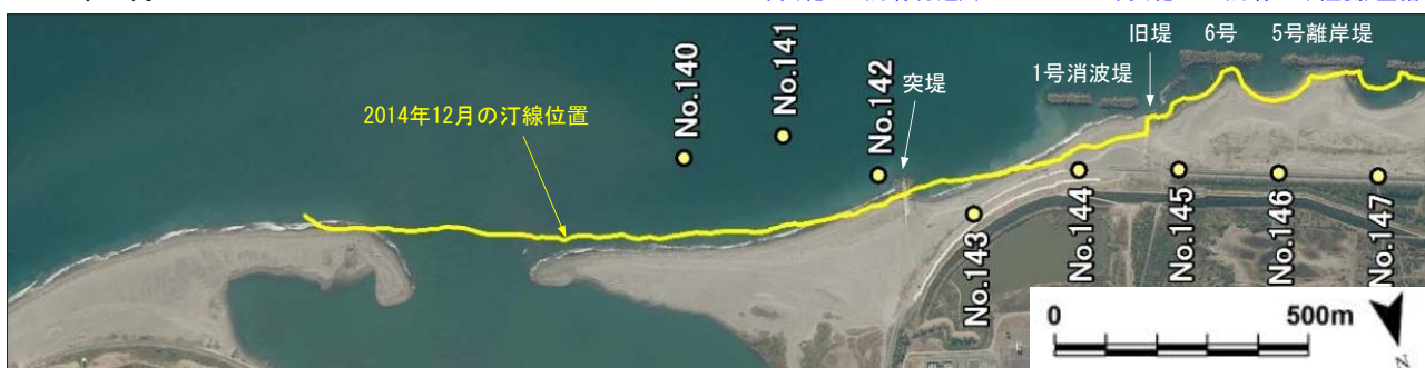
2015年突堤50m (汀線付近)、2020～2021年突堤107m (汀線より陸側) 整備
