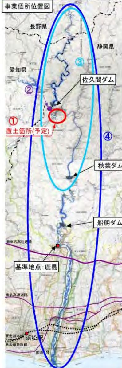
天竜川中下流部の洪水防御をするため、既設の利水専用ダムである佐久間ダムを有効活用して新たに洪水調節機能を確保し、また、佐久間ダムにおいて恒久的な堆砂対策を実施することにより、土砂移動の連続性を確保して貯水池の保全を図るとともに、海岸侵食の抑制等への寄与を目指すものです。
