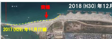
2018 (H30) 年台風24号時は、2013 (H25) 年台風18号と比較してより西からの高波浪が来襲したにもかかわらず、突堤より西側の汀線後退は生じていない
