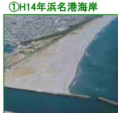
導流堤建設後、東側からの沿岸漂砂により堆積
