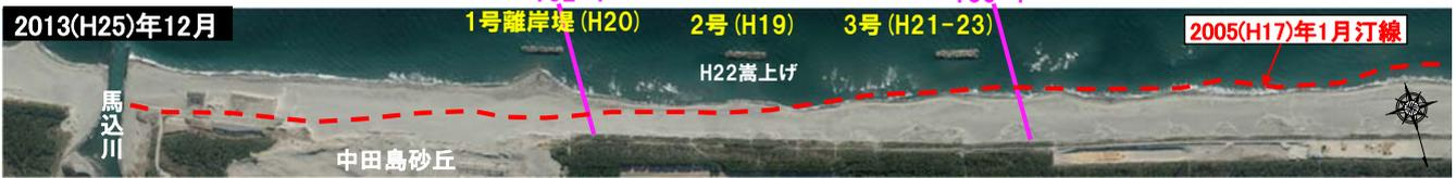
離岸堤周辺では水中部で侵食(バー地形の縮小)が進行しており、水中部は粒径0.2~0.4mm以下の底質で構成されていることから、細砂・中砂分の供給が不足していることが推察される。
