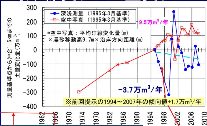
●水深5m以浅は堆砂傾向である。5m以深の変動が激しい
