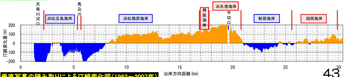
垂直写真の読み取りによる汀線変化図(1962～2007年)
