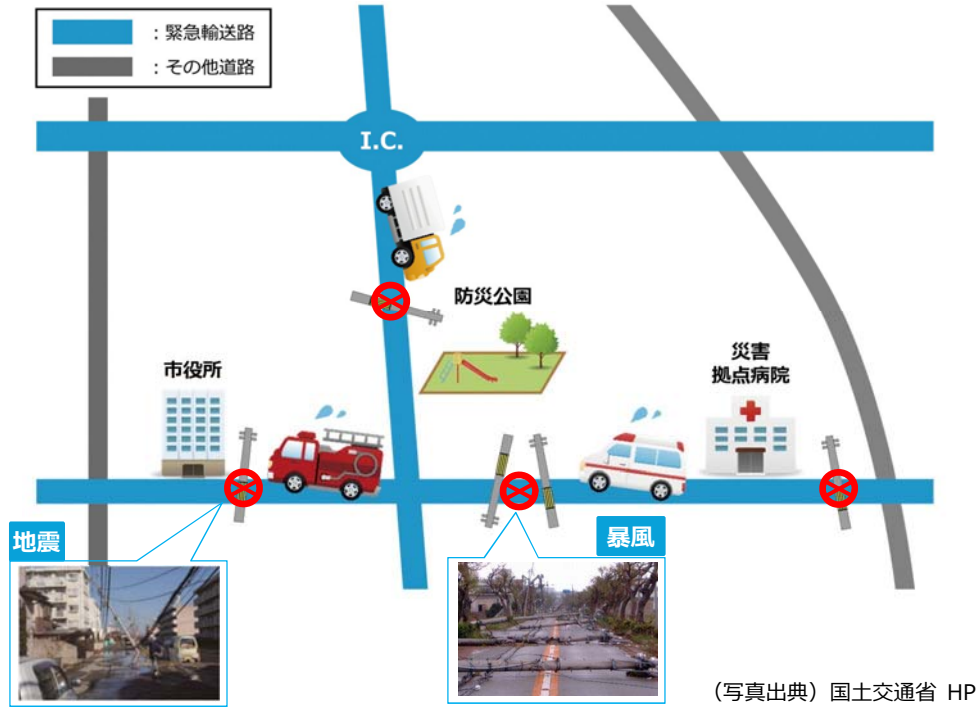
電柱倒壊による道路ネットワークの寸断のイメージ
