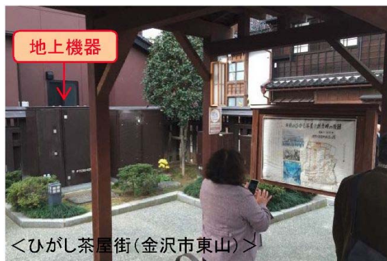
写真 6-1 道路区域外における地上機器の設置事例
