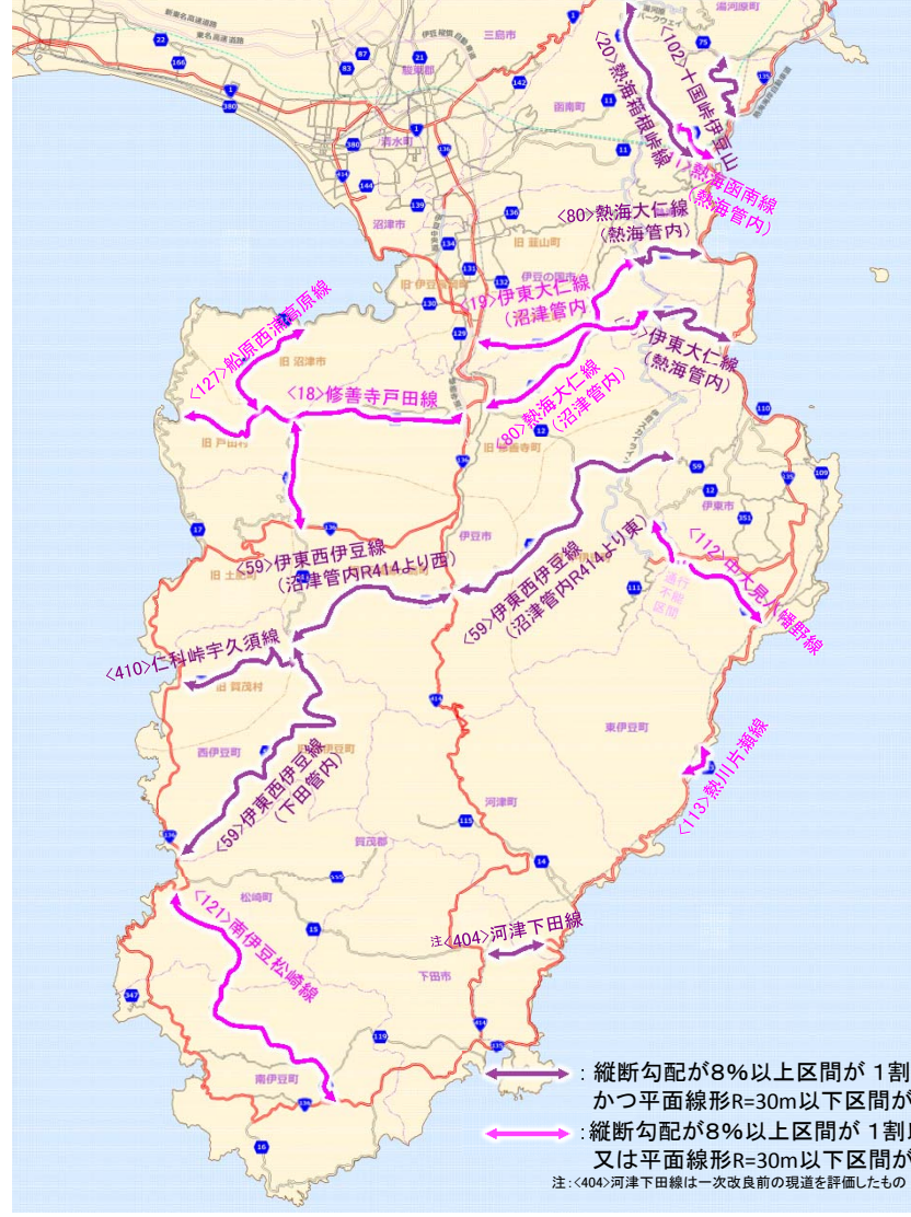
■道路線形不良区間を有する路線
