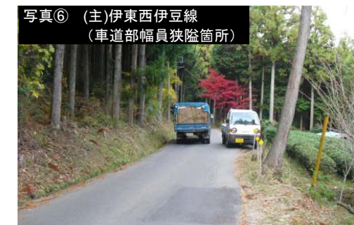
写真⑥ (主)伊東西伊豆線 (車道部幅員狭隘箇所) すれ違いが困難な区間
