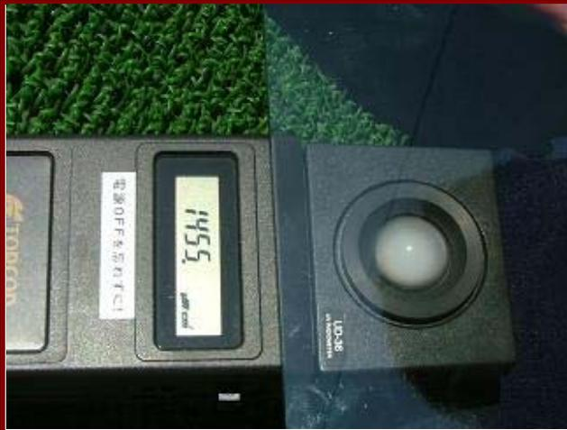
紫外線透過率 施工前 3ミリフロートガラス
