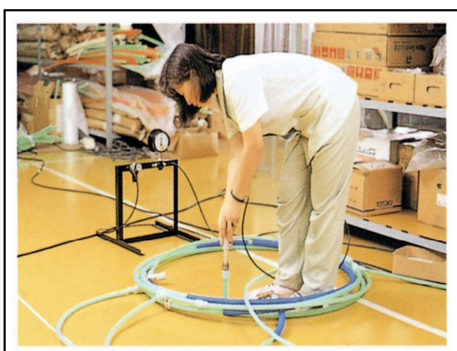
出荷検査(気密テスト例)
