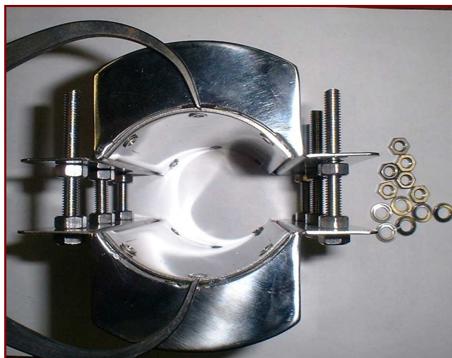
配管外径を測定し装置の内側ナットを調整する
