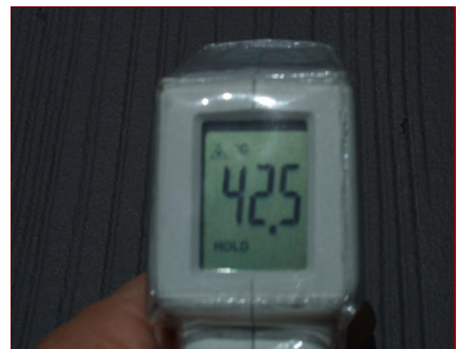
カラーベスト 熱交換塗料 黒色 塗装 外気温21℃
