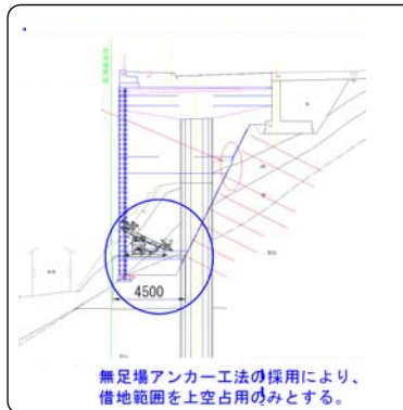
狭隘なヤードでの施工方法
