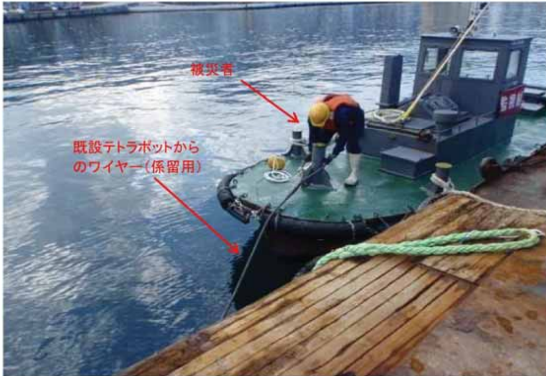
被災者の被災時の作業状況
