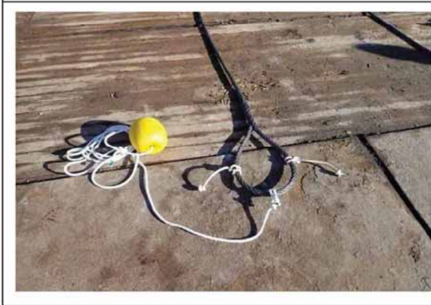
係船用ワイヤー (補助ロープの取付け)
