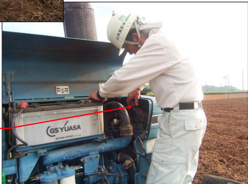
ラジエーターキャップを開けたところ、中から蒸気が噴出し、両手、胴体を火傷してしまった。
