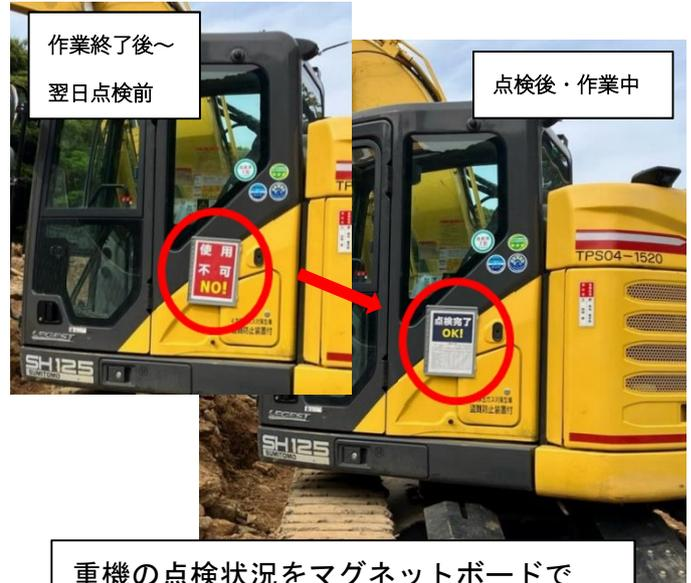
重機の点検状況をマグネットボードで明示、点検漏れを防止！
