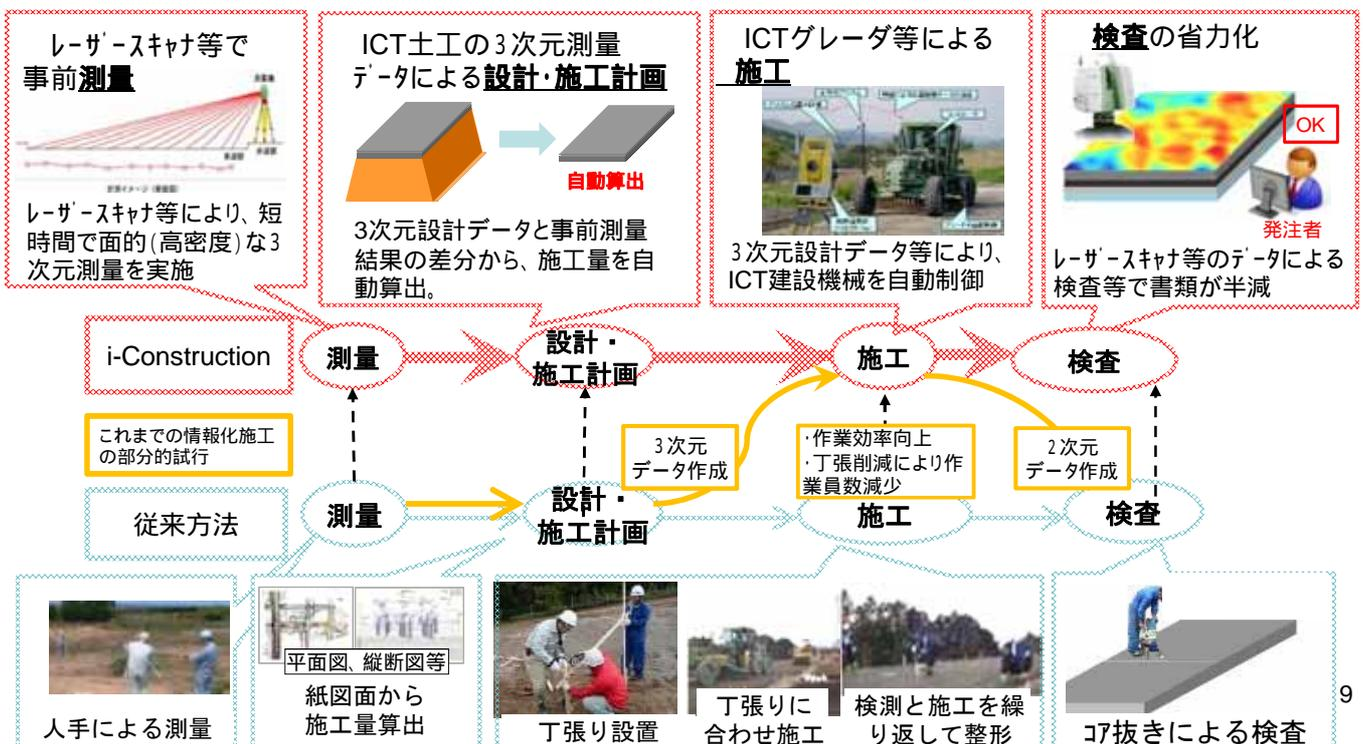
ICT土工同様、起工測量・各層の出来形管理を3次元計測すること、ICT建設機械で施工
