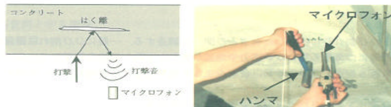
図補 9-4 打音調査（マイクロフォンを併用した場合）
