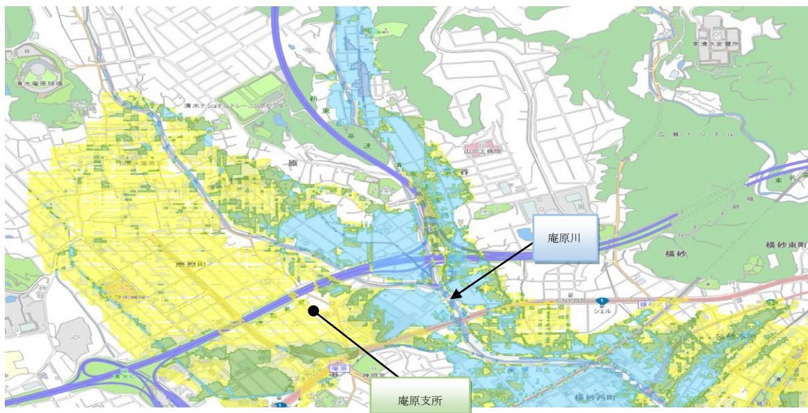
図表 8 洪水による浸水分布(庵原川)
