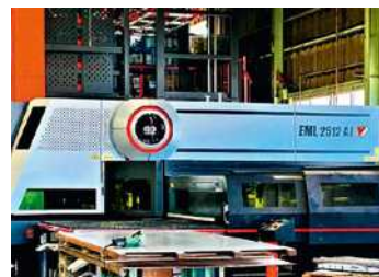
ファイバーレーザー 高速パンチ複合マシン
