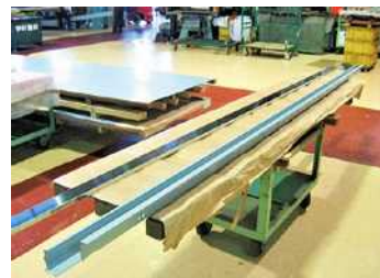
長物加工製品 （レーザーパンチ加工と ベンダー工程を一体化）
