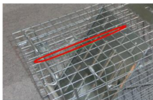
扉部分は、最も狙われやすい部分なので、ストッパーを補強したり、内側から掴めないように板を貼るなどの工夫が必要です。図の赤線は、扉の開放を防ぐために追加した補強用ワイヤーです。
