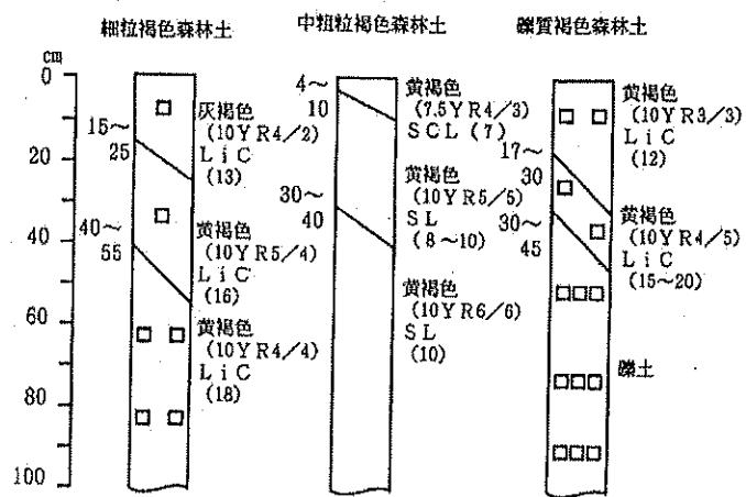
排水の良好なところに分布し、樹園地としての利用が多い。褐色森林土は、土性が細粒（強粘～粘質）、中粗粒（壤～砂質）、礫質（30～60cm 以下礫層）の違いによって、3 土壤統群に区分される。
