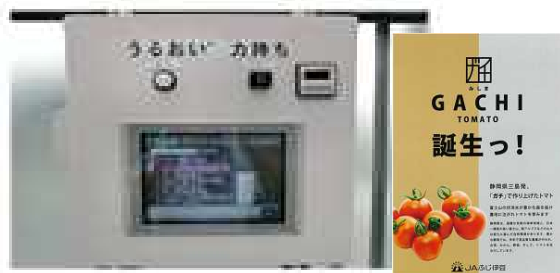
現地実証例 高糖度トマト用給液制御装置
