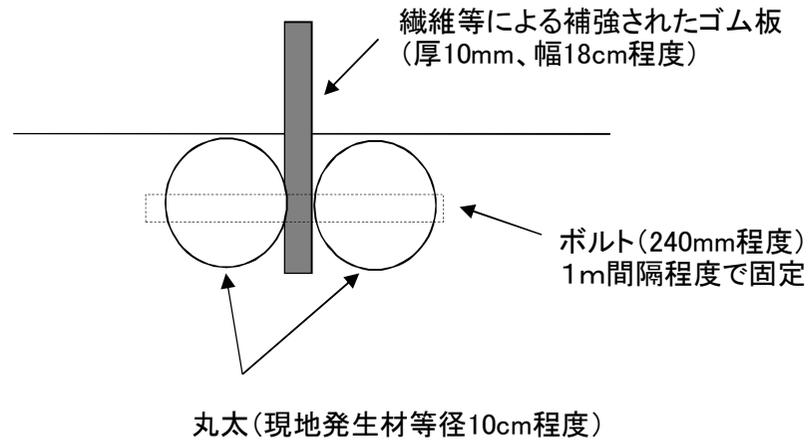
防護柵設置（金網（H=1.8m））参考図
