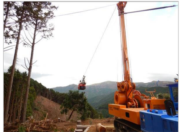
架線を使用した伐採から造林までの一貫作業システム
