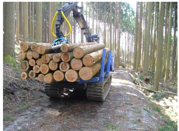
フォワーダによる丸太の運搬(静岡市葵区俵峰)
