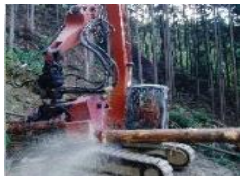
高性能林業機械（プロセッサ）による造材
