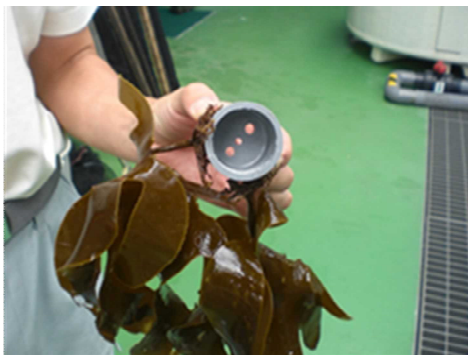
図5 エンドキャップ製移植基盤
