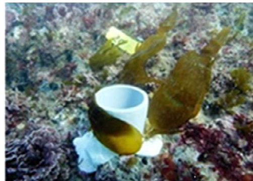
図6 海底に設置した移植基盤
