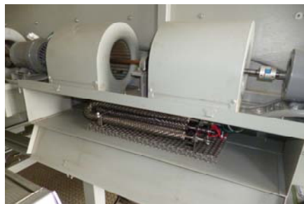
写真 2-3 生葉コンテナの加温機能 （ヒーター内臓送風ファン）
