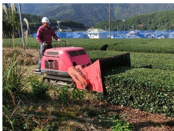
写真2 ハンマーモアによる茶樹破碎
