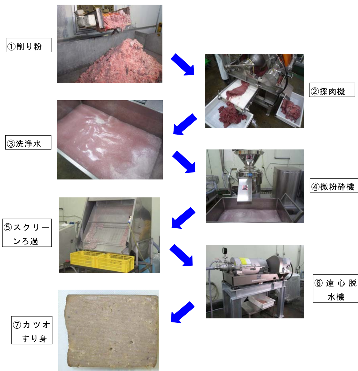
図2 カツオ「削り粉」からのすり身の製造方法
