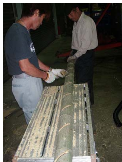
写真1 竹の加工：丸ノコで2本切れ込みを入れドライバでこじってスリットを作る
