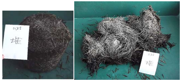
写真8 左 水分80%処理した減容化試料 右 その内部:乾燥して分解が停滞している
