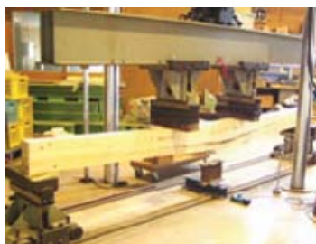
写真3 曲げ試験の様子
