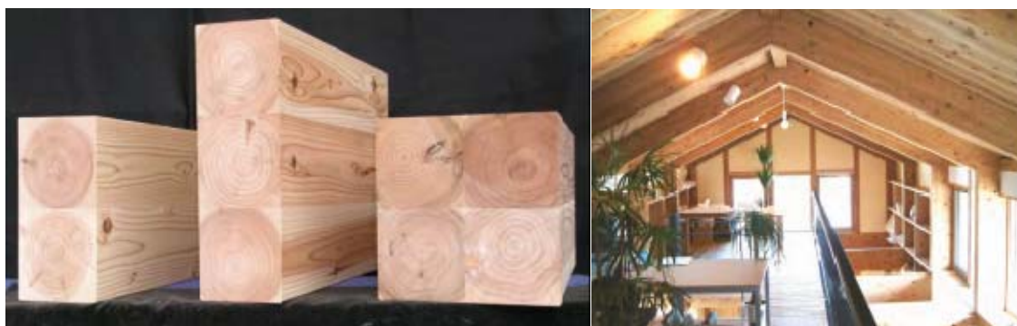
写真1 接着重ね梁（スギ）の種類と使用事例（長野県）
