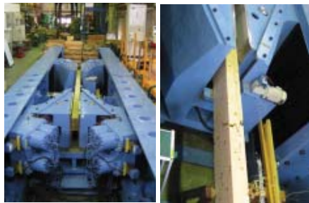
写真5 引張り試験の様子
