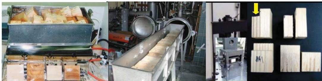
写真8 接着試験の様子（左から、煮沸はく離、減圧加圧はく離、ブロックせん断）
