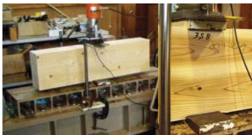
写真7 むり込み試験の様子
