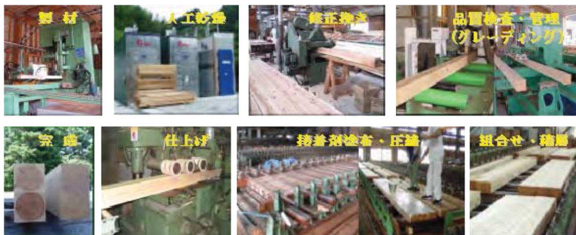
写真2 接着重ね梁の製造工程
