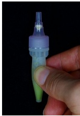
図5 試料の摩砕 (容器を手で30回揉む)
