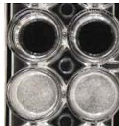
図1 磨砕液処理後に見られる付着物(下側2ウェル)
