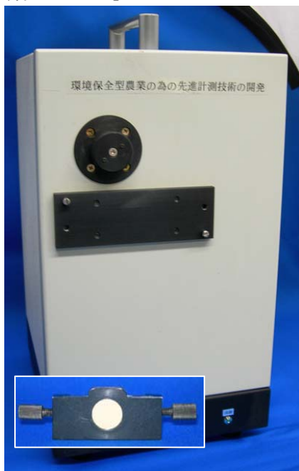
図1 可搬型近赤外分光装置(上)と粉末試料用セル(下)
