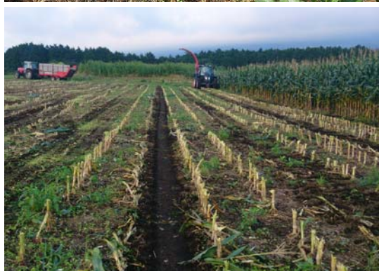
図3 RTK-GPS+自動操舵装置による播種 (上：生育期、下：収穫時)
