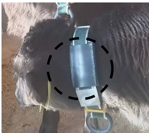
図 1 個体識別用ネックベルトに装着した温度センサー
