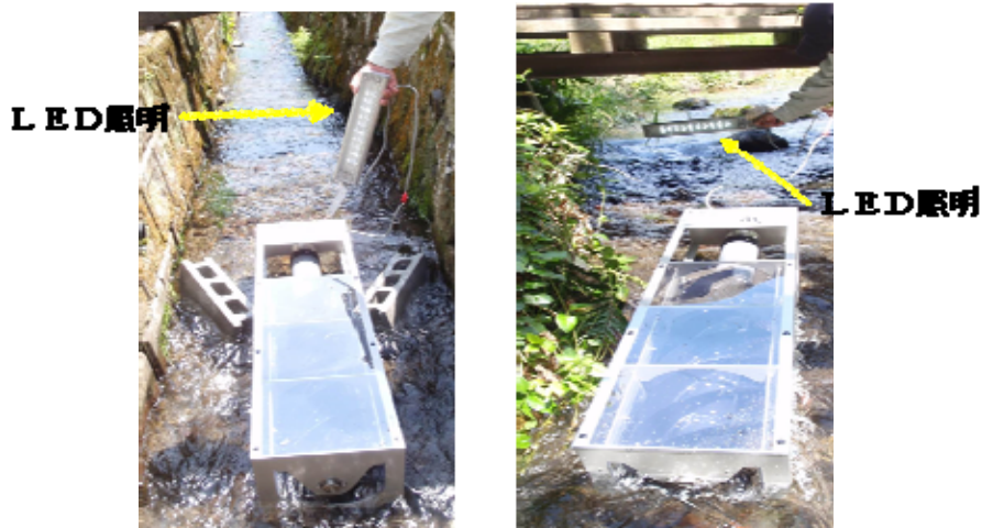
写真 1 湧水地点における発電試験
