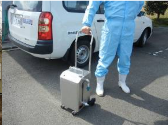
図2 小型のオゾン水車両消毒装置 (重量約17kg、水道と100V電源があれば、 緊急展開が可能)
