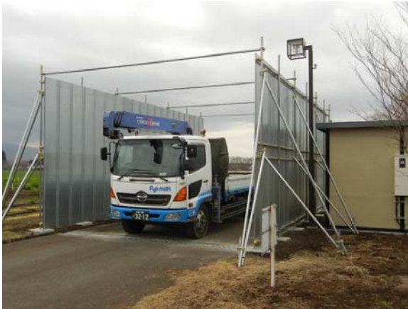
図1 高濃度オゾン水製造装置を利用した 設置型車両消毒装置 (車両1台当たりの消毒コストは約5円)
