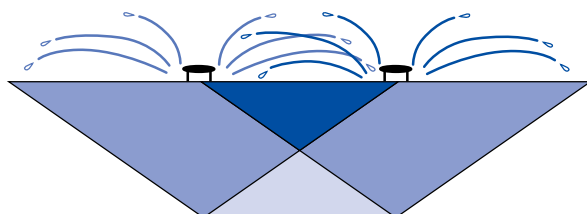
図5 スプリンクラーを重ねた水量のイメージ
