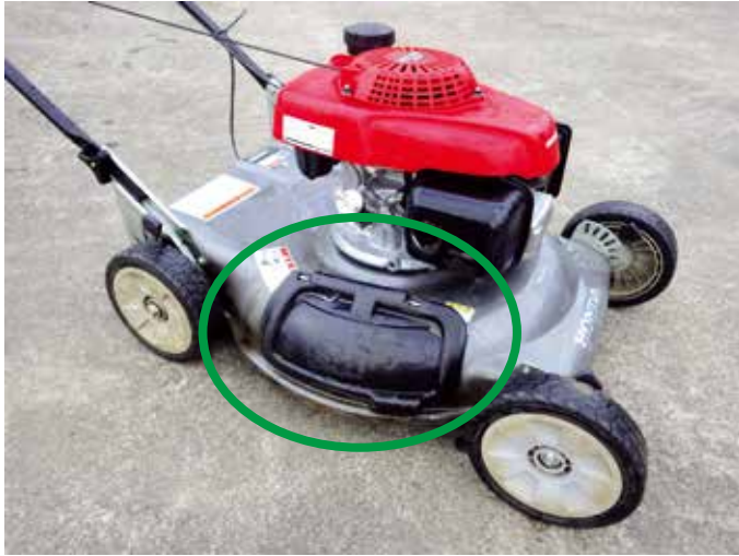
写真12 サイドダクトを閉じた状態
