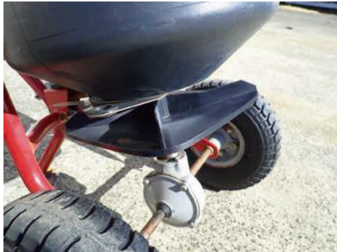
写真9 肥料を飛ばす羽。羽が回転し、上から落ちてきた肥料を遠心力で飛ばす。
