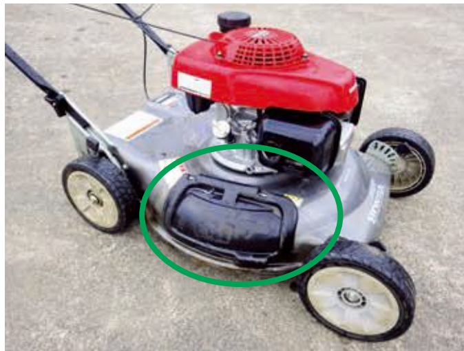
写真22 サイドダクトを閉じた状態
