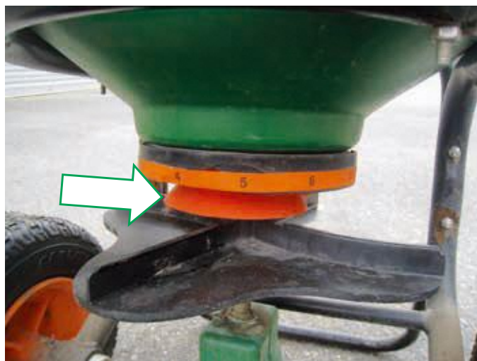
写真13 肥料を左右均等に飛ばすためのヘリカルコーン
