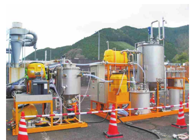
メタン発酵パイロットプラント (左：前処理装置、右：メタン発酵装置)
