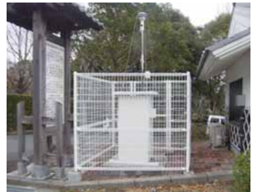
PM2.5自動測定器（掛川市）
